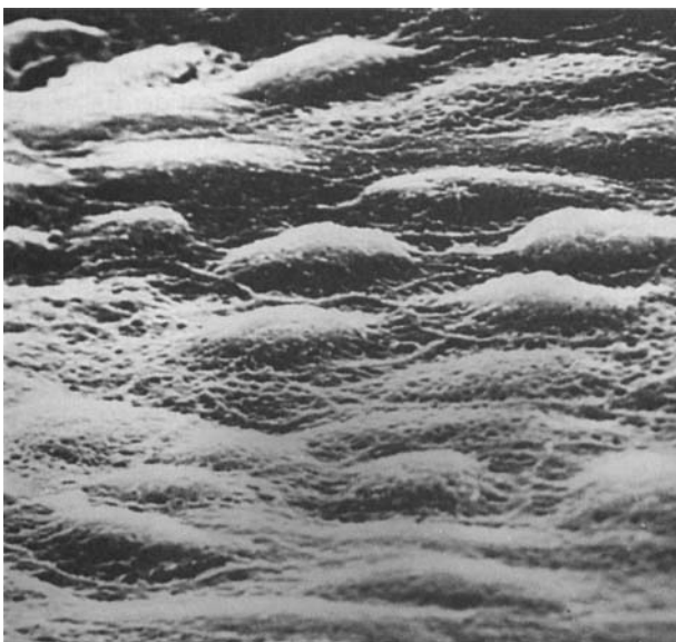
Abb. 27. Reizfreies Einwachsen und Überziehen eines Implantates aus biokompatibler, maschinell bearbeitbarer Glaskeramik mit Epithel im Tierversuch (lichtmikroskopische Aufnahme, Dr. E. Beleites, HNO-Klinik der Friedrich-Schiller-Universität Jena).
