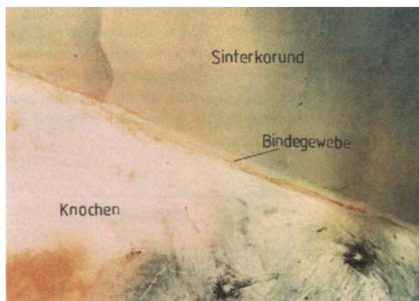
Abb. 12. Knochen-Sinterkorund-Verbund nach 16 Wochen Liegezeit des Implantates im Tierversuch. Das Implantat ist durch eine Bindegewebs(Kollagen)-Schicht eingekapselt und – obwohl biokompatibel – nicht mit dem Knochen verwachsen (lichtmikroskopische Aufnahme nach Alizarinanfärbung von Dr. J. Gummel [32]).
